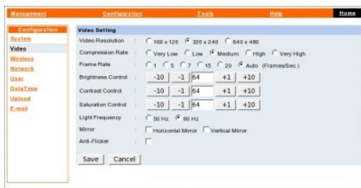
L'impostazione della risoluzione e della compressione video permette di ottimizzare l'impegno della banda dati.
