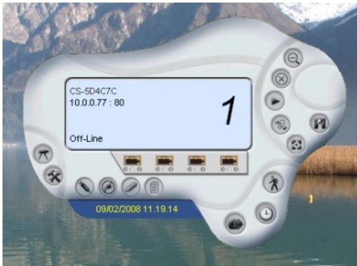
L'interfaccia del software è molto particolare e, seppur graficamente semplice, **un po' confusa**. IPView consente la gestione di **fino a quattro videocamere** in contemporanea e risulta molto utile soprattutto in fase di installazione, in quanto **permette di controllare le impostazioni di luminosità e contrasto contemporaneamente alla visualizzazione delle immagini** trasmesse.
