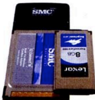
Le nuove schede Express Card sono molto più compatte delle classiche PC Card per slot PCMCIA e CardBus.
