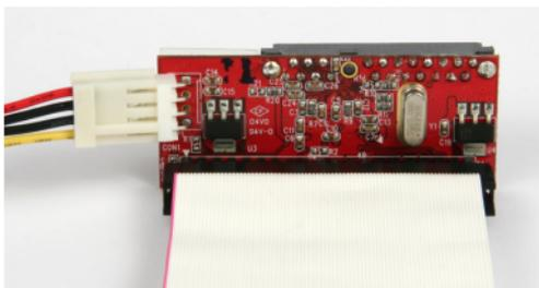
2. Collegate ora il connettore SATA dell'adattatore all'interfaccia SATA del vostro Hard Disk.
