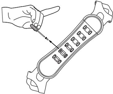
1. Usare il cacciavite in dotazione per rimuovere le viti di blocco del frame.
